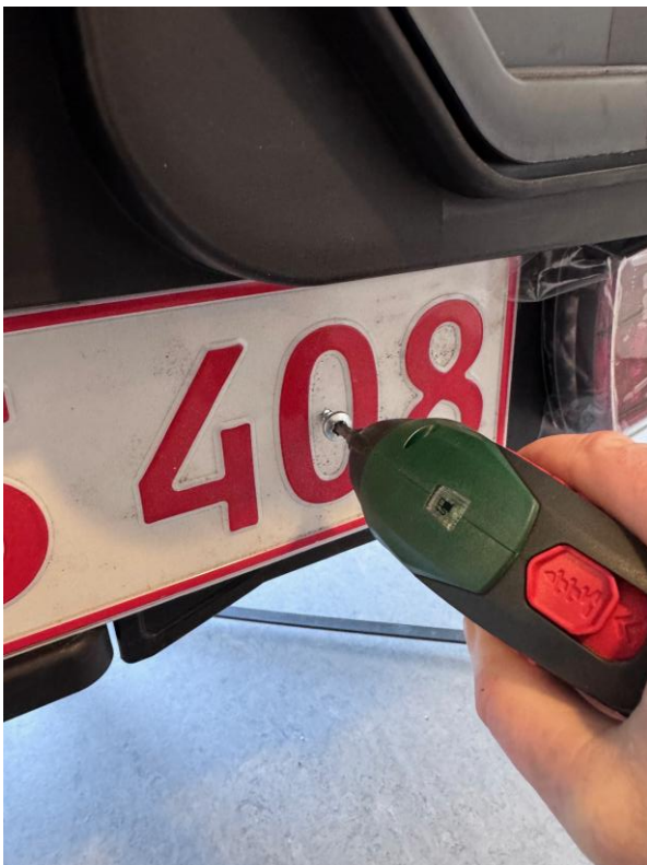
Step 3: Brug 2 selvskærende skruer, fx 6x16 mm
