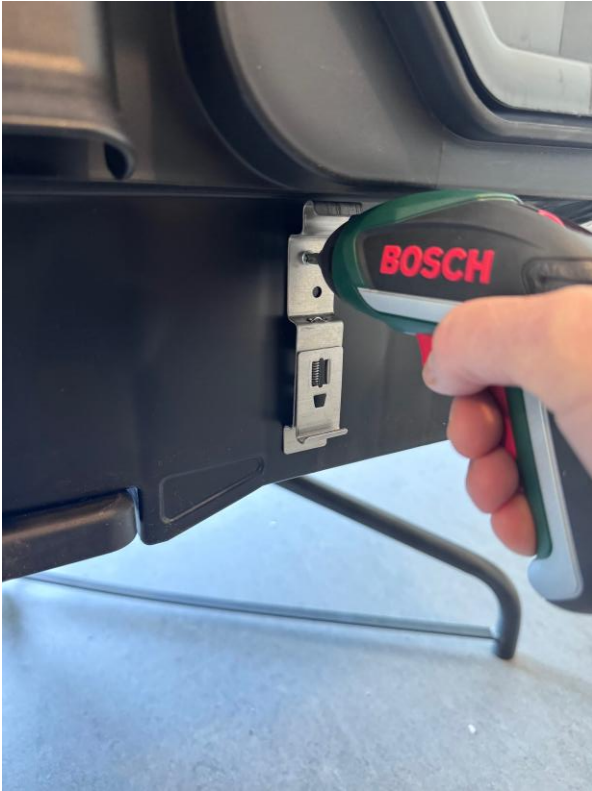
Step 1: Afmonter beslagene
