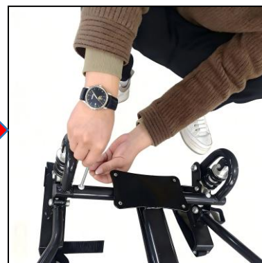
Fastgør højre side med tilhørende skrue
